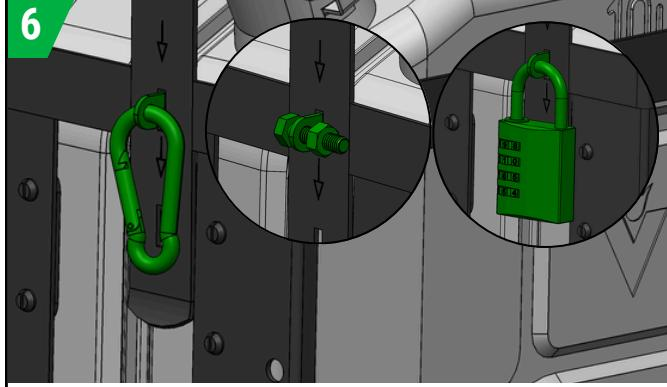
Lai novērstu nejaušu režga atvēšanos, papildu drošībai apskavas cilpā aizāķē karabīni, ieskrūvē M6 skrūvi ar uzgriezni vai aizslēdz ar slēdzeni (nav iekļauts komplektā)
