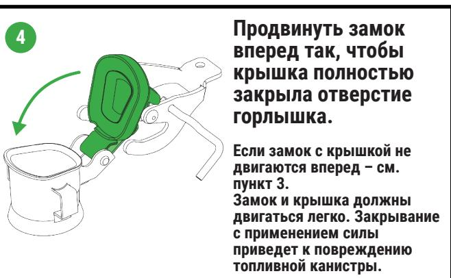
Продвинуть замок вперед так, чтобы крышка полностью закрыла отверстие горлышка.
