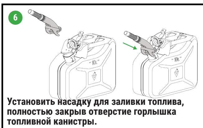
Установить насадку для заливки топлива, полностью закрыв отверстие горлышка топливной канистры.
