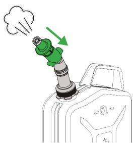
Прижать наконечник насадки для заливки топлива, чтобы уменьшить давление паров топлива.
