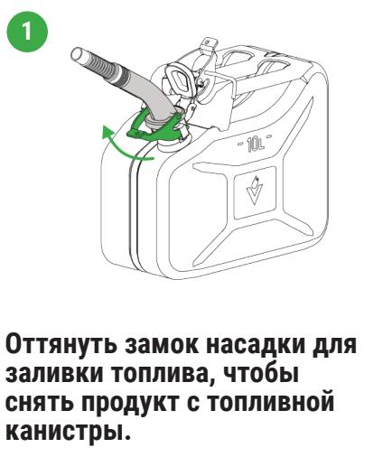
Оттянуть замок насадки для заливки топлива, чтобы снять продукт с топливной канистры.
