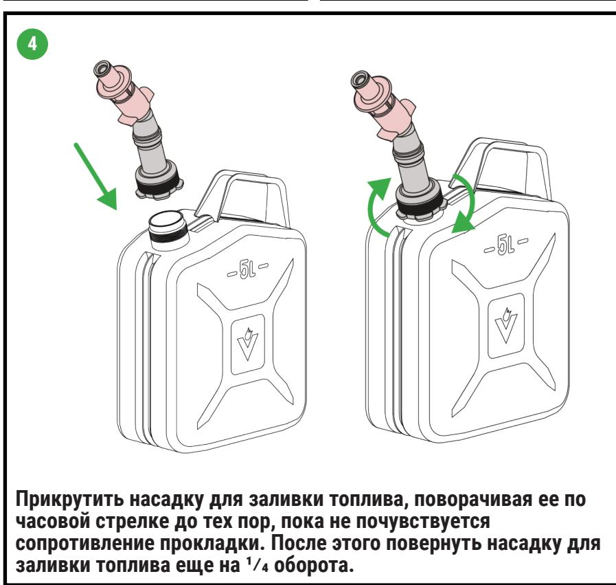
Прикрутить насадку для заливки топлива, поворачивая ее по часовой стрелке до тех пор, пока не почувствуется сопротивление прокладки. После этого повернуть насадку для заливки топлива еще на  $\frac{1}{4}$  оборота.
