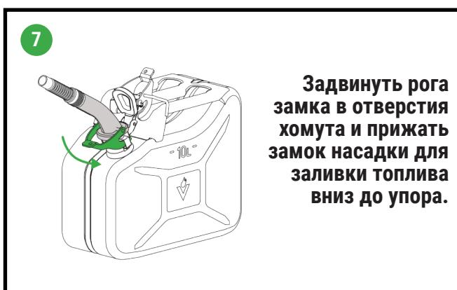
Задвинуть рога замка в отверстия хомута и прижать замок насадки для заливки топлива вниз до упора.
