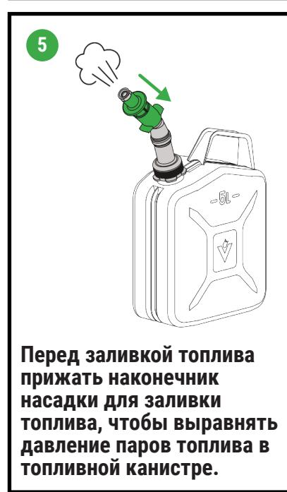
Перед заливкой топлива прижать наконечник насадки для заливки топлива, чтобы выравнять давление паров топлива в топливной канистре.
